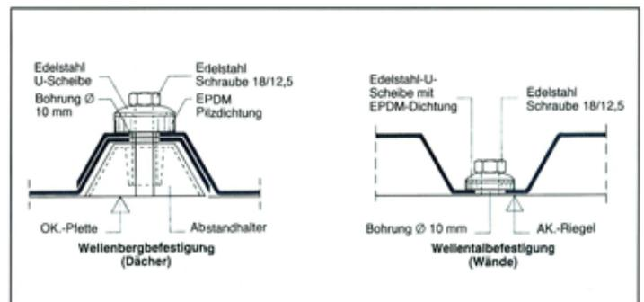
**Schrauben:** Die Dachbefestigung erfolgt auf dem Wellenberg ... Abstandhaltern. Im Wandbereich im Wellental befestigen. Befestigungen sind entsprechend der ONDEX®-Bauanleitungen und bauaufsichtlicher Zulassung auszuführen.
