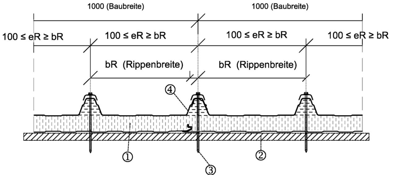
**Direkte Befestigung der Elemente "PENTA W" am Untergurt**
