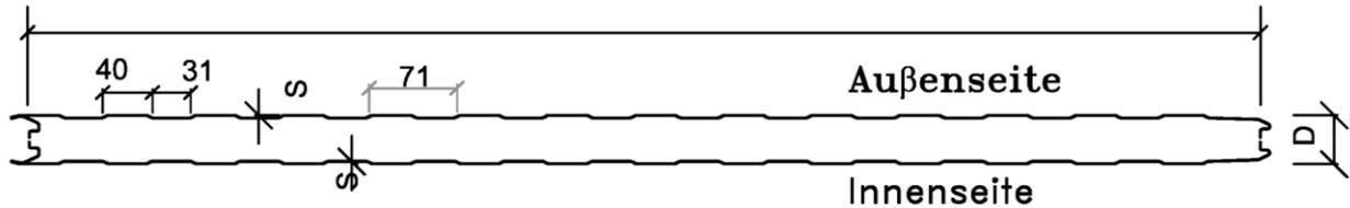
Detail der Verbindungsfugen:
